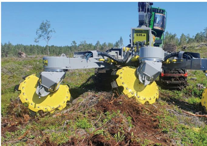
Le Bracke S35.a peut être monté sur un scarificateur à une, deux ou trois rangées.
