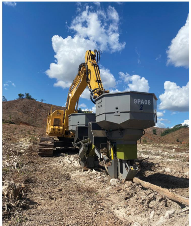
Le Bracke P22.b est monté avec un rotateur et un lien qui permet de planter les plants en position verticale.
