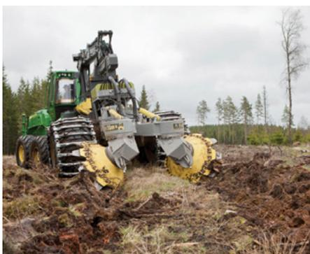
Le système hydraulique est à détection de charge.
