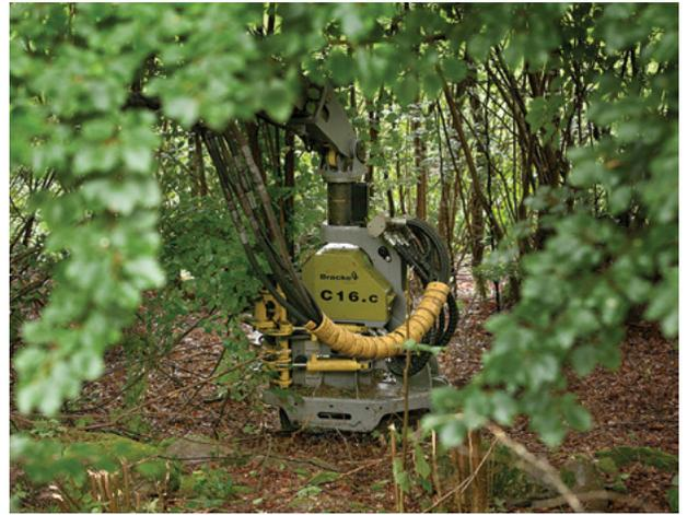
La Bracke C16.c est une tête d'abattage accumulative destinée aux coupes d'éclaircie et la bioénergie.
